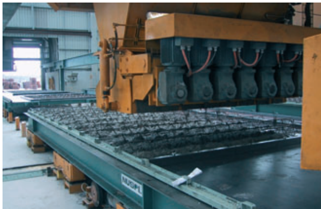
Rütteltisch für sichtbare Betonelemente
