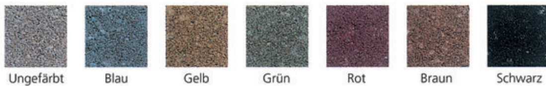
Abhängigkeit der Farbschattierungsskala für W/Z-Verhältnis 0,27 mit Weißzement
