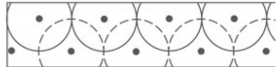
Überlappen sorgt für volle Verdichtung
