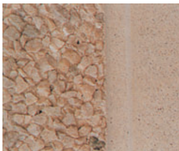
Abgetragene und geätzte Oberfläche mit Lahn-Quarz 5/8 (deutscher Zuschlagstoff)
